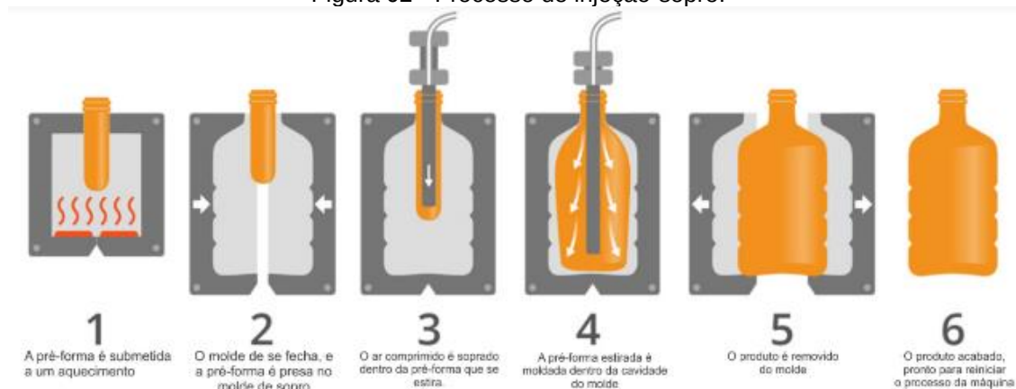
Figura 02 - Processo de injeção-sopro.
