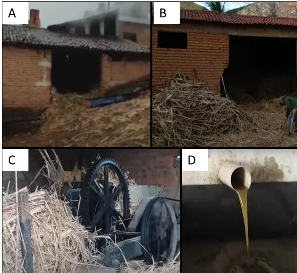
Figura 1 - Galpão de armazenamento e moagem de cana (A e B), Moagem da cana (C), tubulação de escoamento e tanque de armazenamento do caldo da cana (D), em engenhos tradicionais de rapadura no Sertão Pernambucano.
