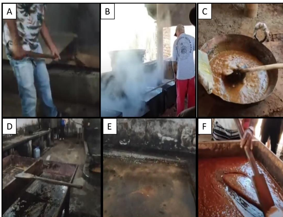
Figura 2 - Concentração do caldo da cana em fomalhas (A e B), Tacho de finalização do ponto de rapadura (C), cocho de bateção de rapadura e sala de preparo (D, E e F) em engenhos tradicionais de rapadura no Sertão Pernambucano.
