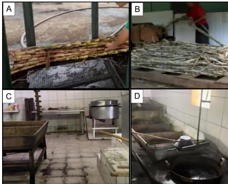
Figura 5 - Agroindústria nas normas das BPF. Fornalha de concentração do caldo (A), Pessoal uniformizado (B, C e D), Portas e janelas com tela contra insetos (B), Pia para higienização (D)
