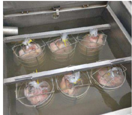
Figura 2 – Imersão dos frangos congelados embalados e seguros em uma cesta de inox em banho-maria a 42°C, para realização da análise de Dripping Test (Fonte: Arquivo pessoal).
