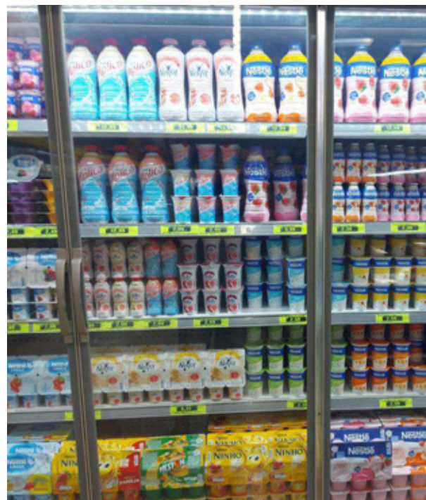
Figura 3. Expositor vertical refrigerado com portas.
