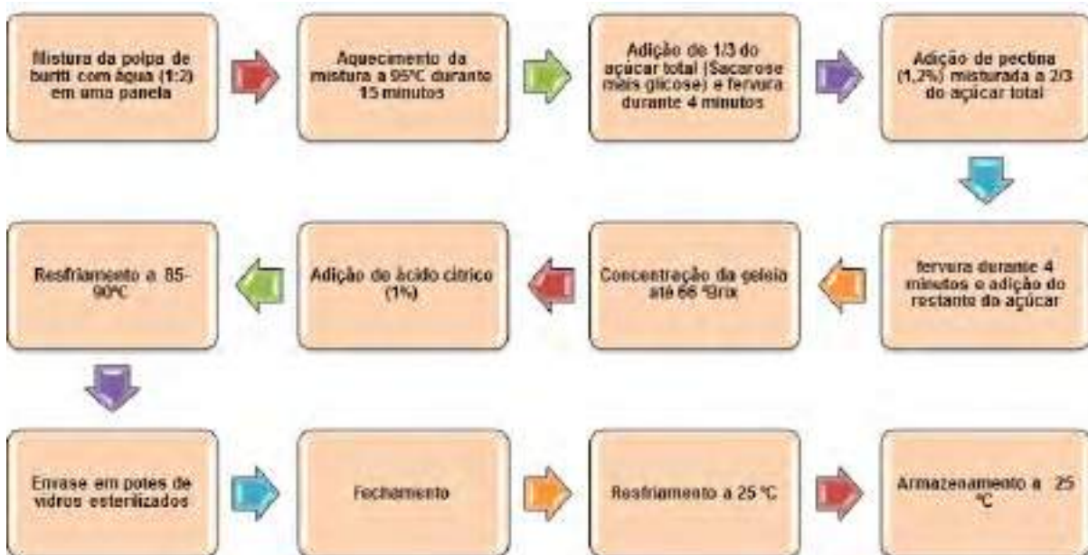
Figura 1. Etapas do processamento da geleia de polpa de buriti.
