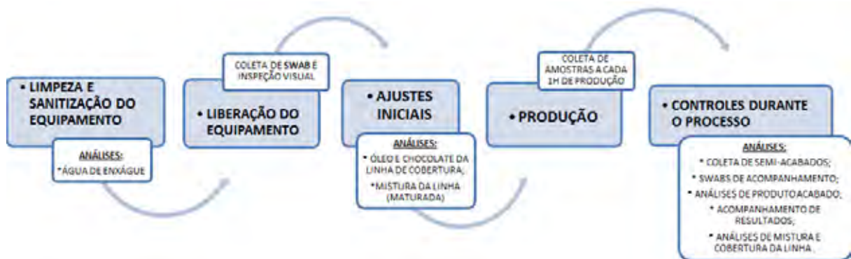
Figura 1: Fluxograma do controle microbiológico de uma linha de produção de picolés
