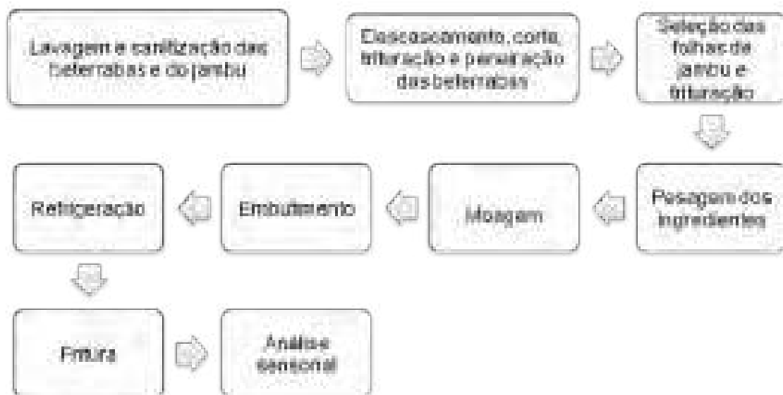
Figura 1 – Fluxograma de obtenção da linguiça com corante natural extraído de beterraba e adição de jambu
