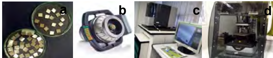
Figura 1 - Material e equipamentos utilizados. Em (a) cupons de aço inoxidável AISI 304; (b) (porta amostra e (c) MEV Phenom-FEI; Em (d) Perfilômetro Dektak Veeco 150. Fonte: Imagens a,c e d são de arquivo pessoal e a imagem b do manual do MEV.
