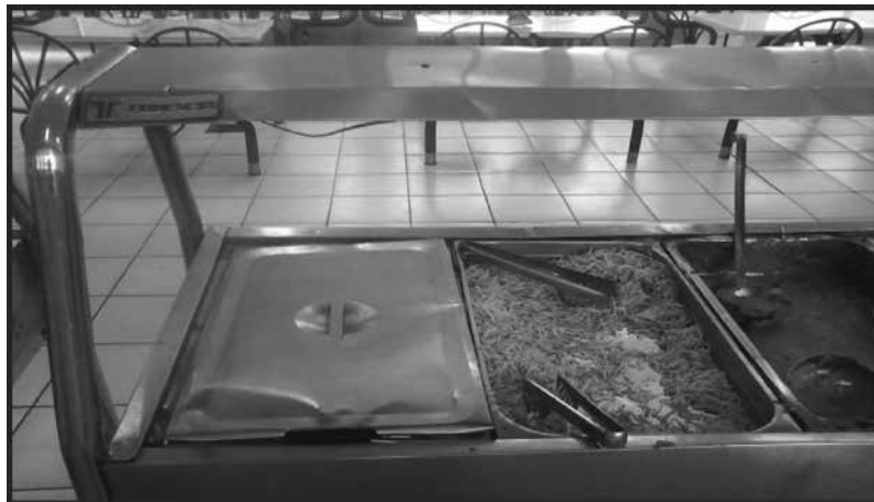
Figura 4 - Demonstração de balcão de distribuição sem barreira contra contaminação em uma UAN localizada na Cidade do Rio de Janeiro.
