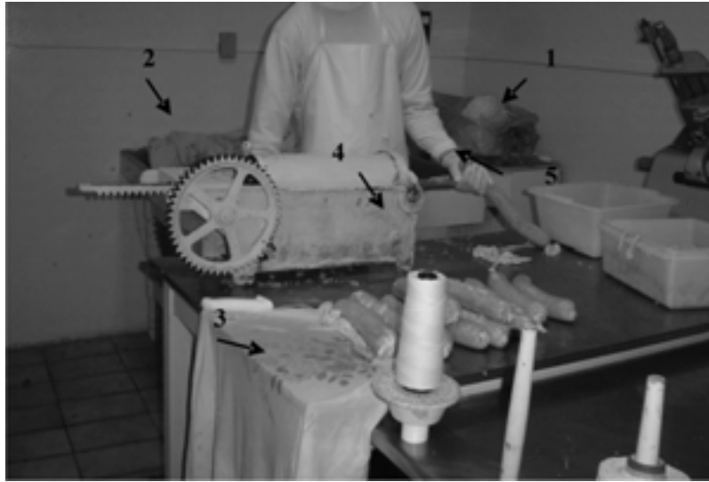
Figura 1 - Evidência de materiais não comuns à atividade de produção: 1. embalagens sobre a pia; 2. toalha de pano cobrindo a matéria-prima; 3. toalha de pano estampada sobre a mesa; 4. máquina de embutir não conservada adequadamente; 5. ante-braço do manipulador exposto.
