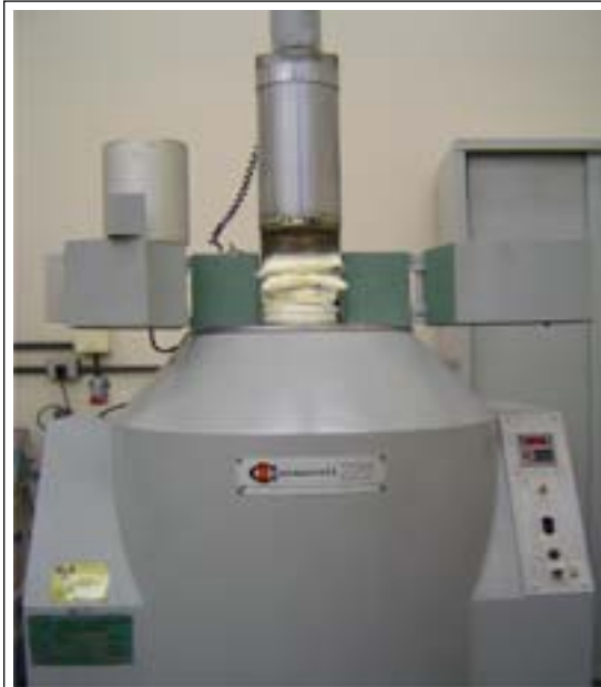
Irradiação de alimento fortificado em pó, em fonte Gammacell 220.
