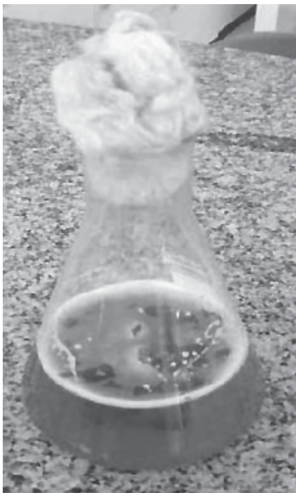
Figura 2- Fermentação com cascas de laranja imobilizadas feita em erlenmeyer.
