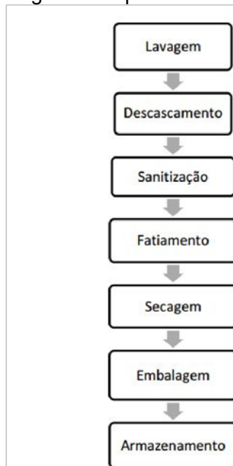
Figura 1- Fluxograma do processamento de chips de batata doce
