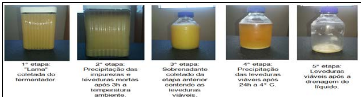
Figura 1. Imagem e descrição das etapas do processo de lavagem das leveduras.
