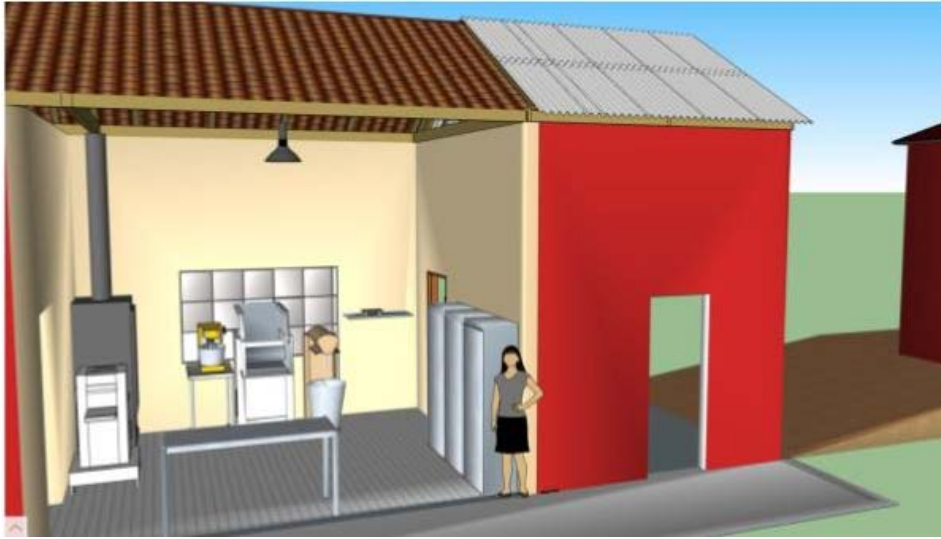
Figura 1. Ilustração do layout original da área de manipulação e disposição dos equipamentos da panificadora.
