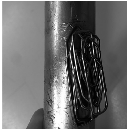
Figura 8 - Clips presos pelo magnetismo conduzido.
