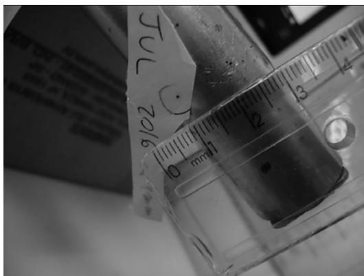
Figura 5 - Partícula menor que 1mm retida pela barra magnética.
