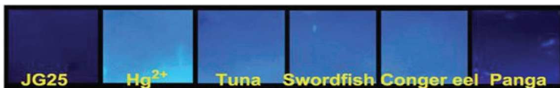
Da esquerda para a direita, amostras do polímero JG25 em contato com água (JG25), uma solução de mercúrio (Hg2+) e amostras de peixes (atum, peixe-espada, congrio). Credit: T. Torraba et al./ChemComm
