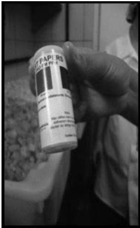
Figura 3 - Fitas teste para dosagem de cloro em ppm (A); fita imersa na solução clorada indicando 200 ppm de cloro (B).
